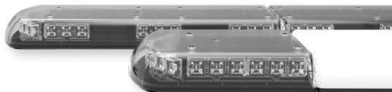
Le cache central de 457mm combiné avec les cabochons extérieurs de 305mm permettent plusieurs configurations plus courtes et offrent une polyvalence améliorée aux véhicules plus petits.
